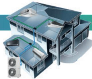
Este sistema inteligente de ar condicionado tem uma unidade externa (condensadora) que permite o controle individual de várias unidades internas (evaporadoras) e variando os modelos. Os fluidos refrigerantes são ecológicos, por isso o VRV/VRF não agride o ecossistema.
